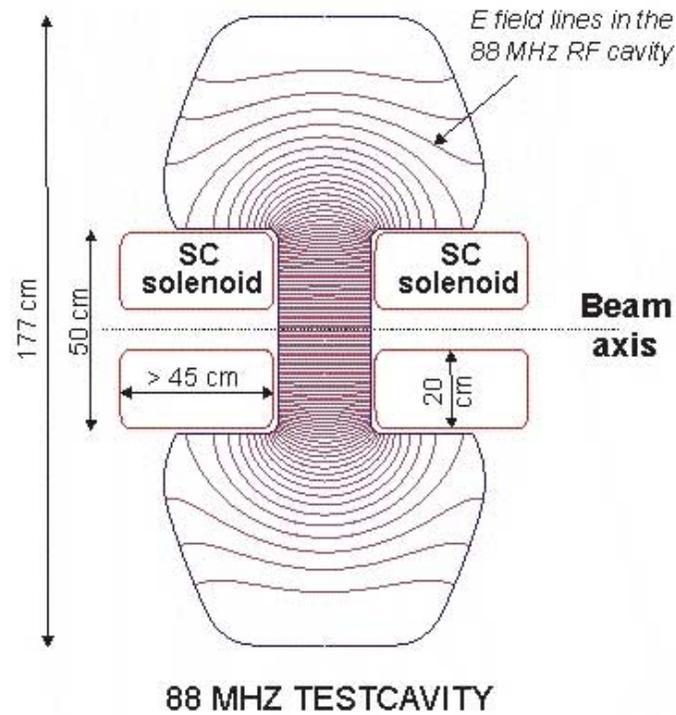
**SUPERCONDUCTING SOLENOID ASSEMBLY**
